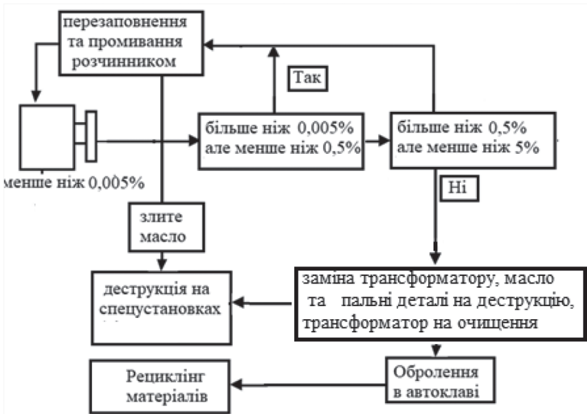
Мал. 1.1 Рекомендовані операції із знешкодження трансформаторів з ПХД, що експлуатуються [2]
