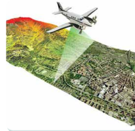
Рис. 4.4. Принцип повітряного лазерного сканування
