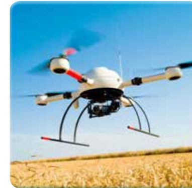
Рис. 1.32. Квадрокоптер (дрон) – моніторинговий пристрій для збору потокової географічної інформації
